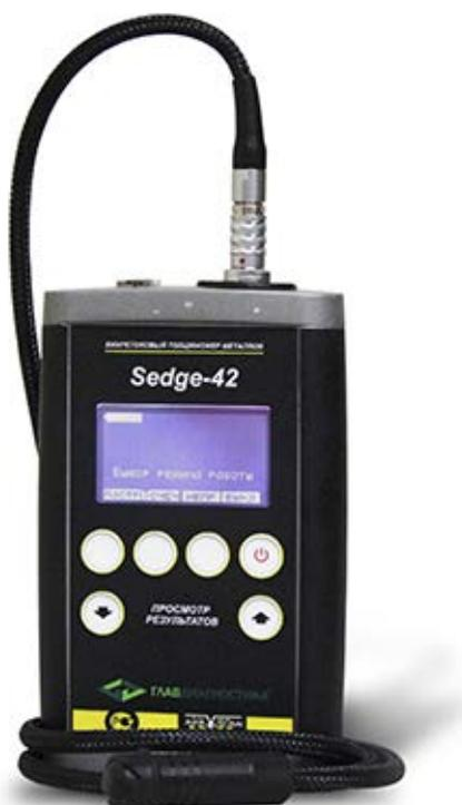
Бесконтактный вихретоковый толщиномер основного металла Sedge-42 - предназначен для измерения толщины изделий из ферромагнитных металлов в сверхмалом диапазоне толщин: от 1 до 2000 мкм.
