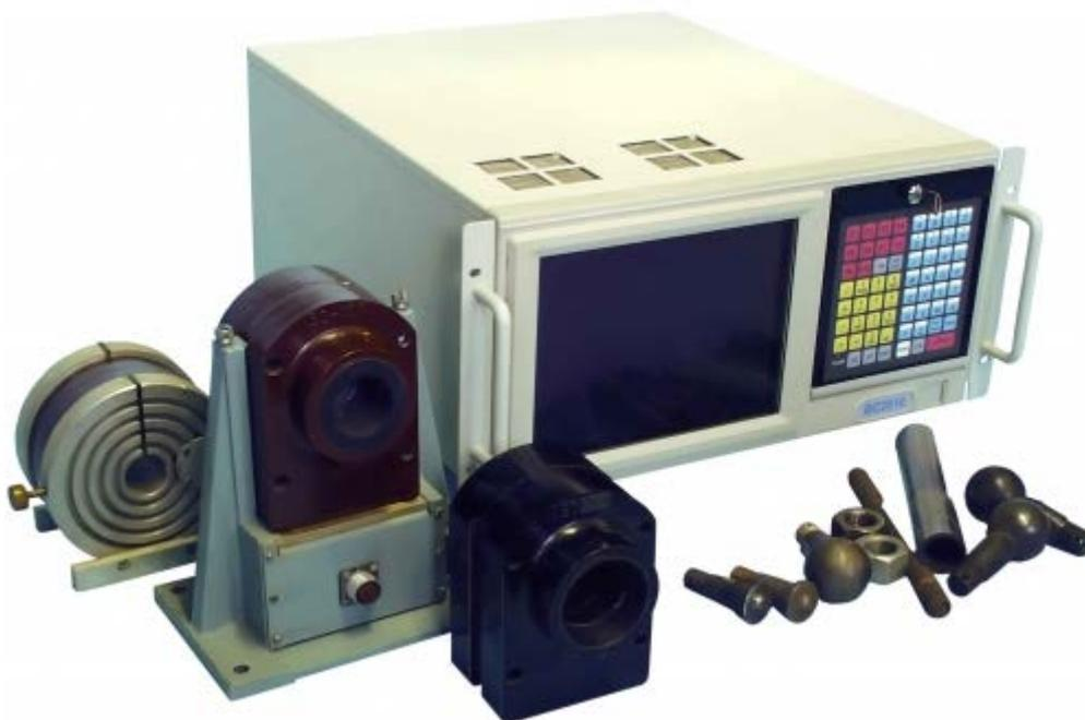
Вихретоковый структуроскоп ВС-2010 предназначен для обеспечения входного контроля при оснащении линий непрерывной сортировки черного металлопроката: труб, прутков, лент, а также для сортировки по режимам термообработки однотипных деталей. Разбраковка по марке стали, твердости и пределу прочности.
