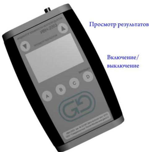
Поскольку количество клавиш невелико, каждая из них выполняет несколько функций, в зависимости от режима, в котором находится прибор. Функция, выполняемая каждой клавишей, расположенной на передней панели прибора, указывается надписью над этой клавишей.
