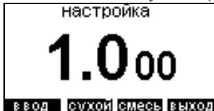
здесь крупные цифры обозначают диэлектрическую проницаемость среды.
