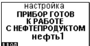
6.13. Прибор готов к работе с данным сортом. При выключении прибора и при замене элементов питания настроочные коэффициенты сохраняются. Поэтому в дальнейшем процедура настройки на данный сорт не требуется.
