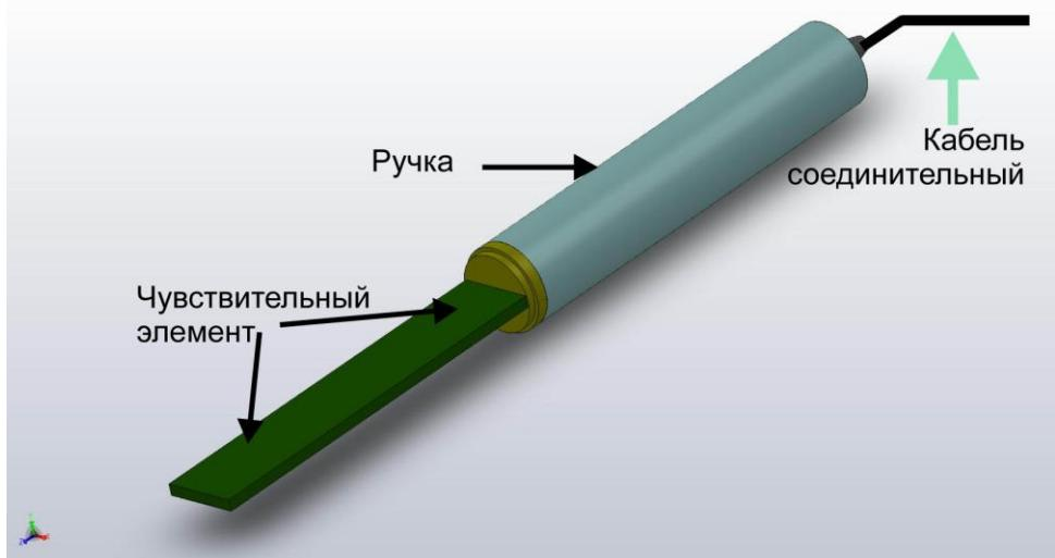
Конструкция чувствительного элемента позволяет сократить время контроля по сравнению с датчиками ЭП-201, ЭП-202, у которых контролируемая жидкость находится между измерительными пластинами и заполняет контрольный объём очень медленно.
