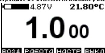
7.2. В верхней строчке отображается напряжение питающей батареи - рядом со стилистическим изображением гальванического элемента и температура среды в которой находится датчик. В центре экрана крупными цифрами - диэлектрическая проницаемость среды. В нижней строчке - назначение кнопок - над каждой из них.
