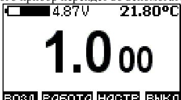
Крупные цифры в центре экрана обозначают диэлектрическую проницаемость среды внутри датчика. Значение остальных сообщений описано в п.
