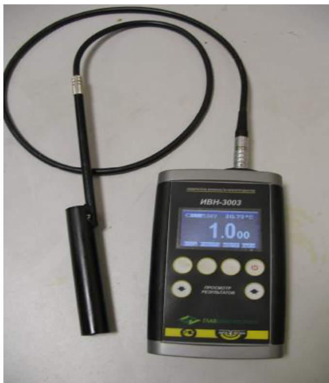
Рисунок 1 - Внешний вид анализатора влажности нефтепродуктов ИВН-3003 АКАСКАН с датчиком ИВН Б-1
