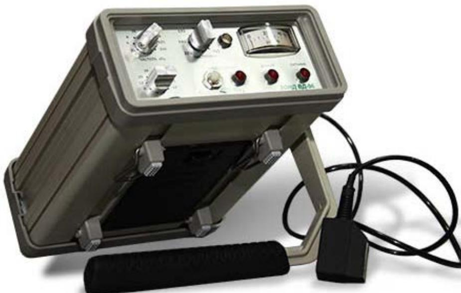
Универсальный вихретоковый дефектоскоп Зонд ВД-96 предназначен для обнаружения трещин, коррозии, несплошностей на поверхности объекта контроля и приповерхностном слое черных и цветных металлов, выявления мест утонения.
